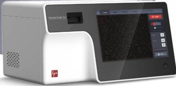
QUANTOM Tx™ 微生物セルカウンターは、個々の細菌細胞を自動的に識別し、数分で細胞数をカウントします。細菌（バクテリア）は非常に多様な生物のグループであり、さまざまな形状、サイズ、配置の組み合わせがあり、定量化を困難なものにしています。
